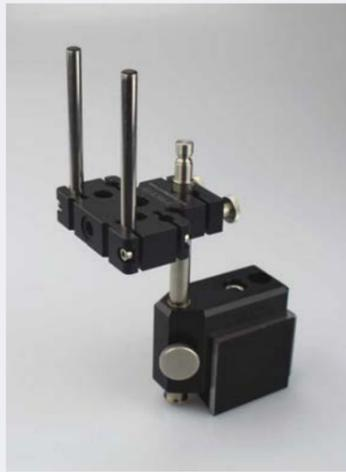
Sensorhalterung auf Messtaster montiert
