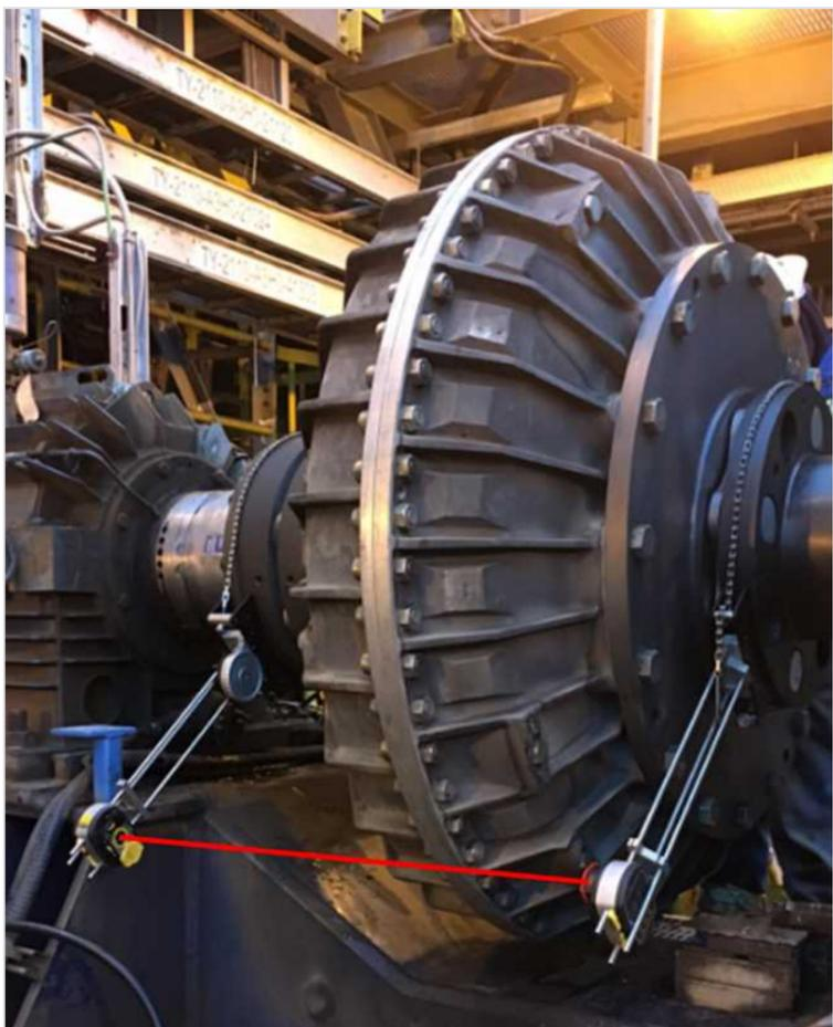
Kettenspannvorrichtung für große Durchmesser, ALI 2.460
