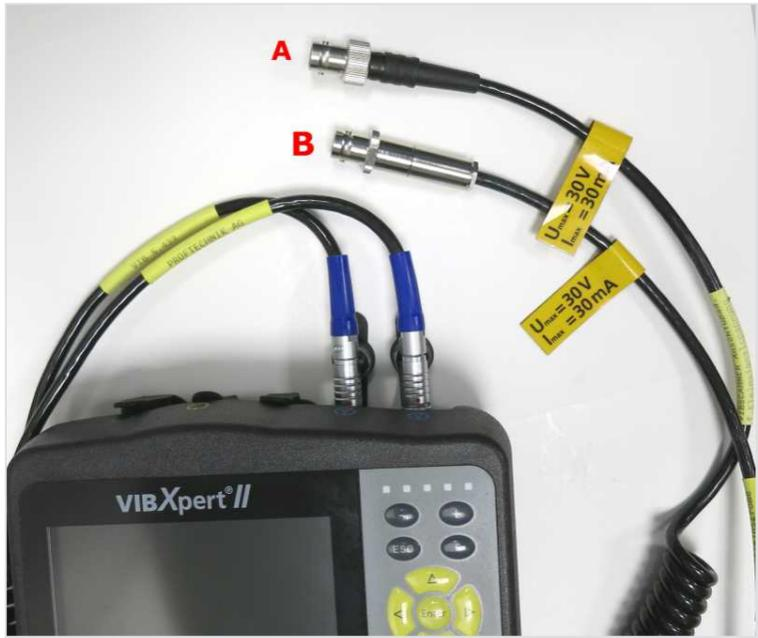
Sensorkabel zur Messung von Signalkleinspannung (A) und Signalkleinstrom (B) am VIBXPERT II angeschlossen.
