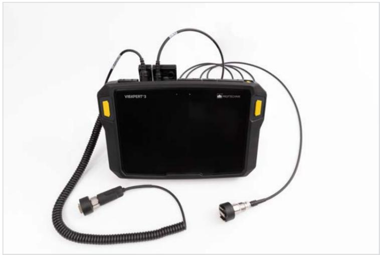
Sensor VIB 6.142 mit Spiralkabel VIB 5.236 und geradem Kabel VIB 5.037 an VIBXPERT 3 angeschlossen.
