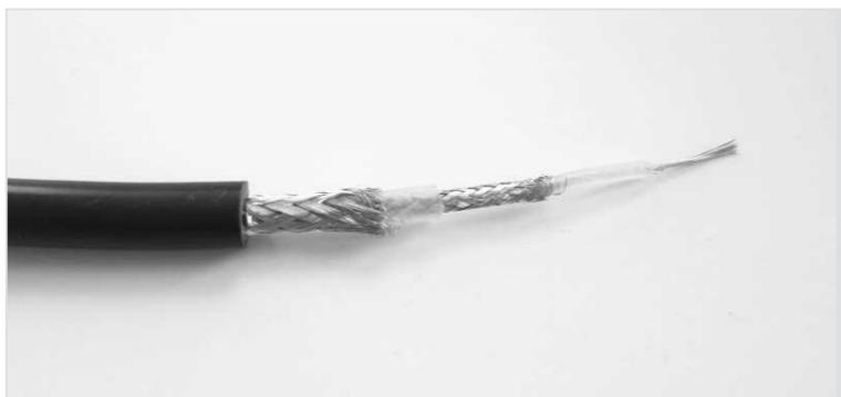
Triaxialkabel mit doppelter Schirmung.
