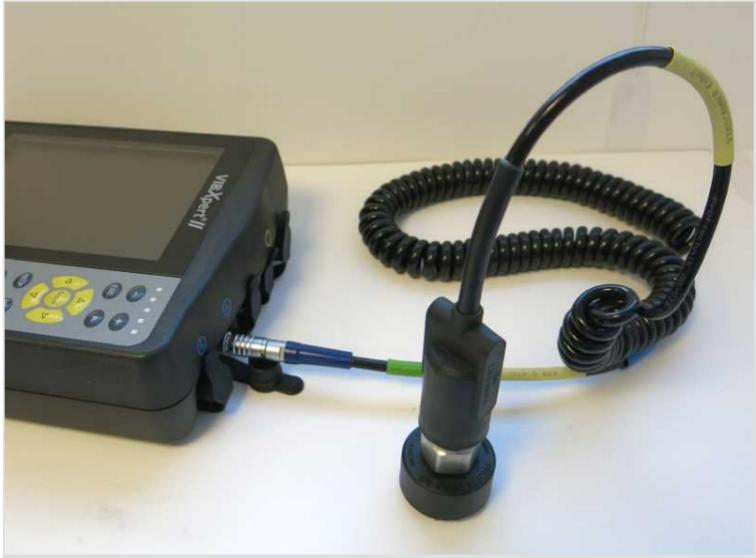
Sensor VIB 6.142 mit Spiralkabel VIB 5.436 an VIBXPert II angeschlossen.
