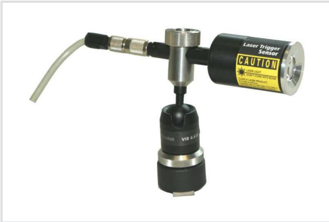
Drehzahlmessung: Stativ (1), Reflexfolie auf der Welle (2) und Drehzahlsensor (3).
