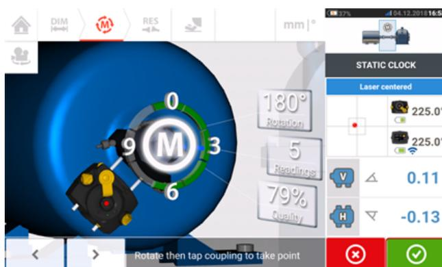
7. Wenn Sie mit dem Aufnehmen der Messpunkte über einen Drehwinkel von 70° Grad fertig sind, tippen Sie auf
