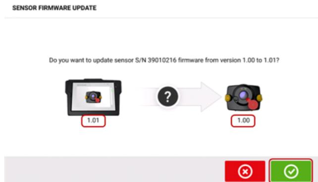
Auf dem Bildschirm wird darauf hingewiesen, dass eine neuere Sensor-Firmware über das robuste Touch-Gerät verfügbar ist. Tippen Sie auf
