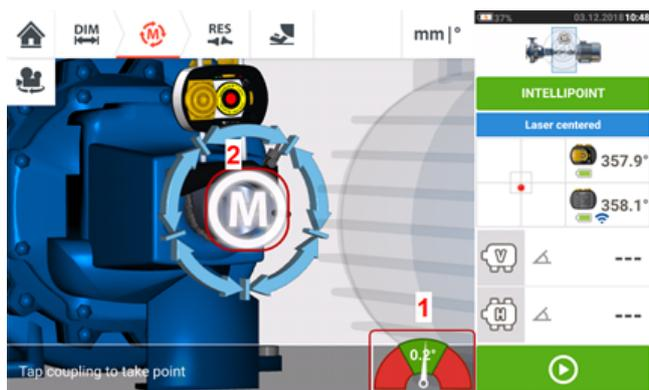
1. Nachdem der Laserstrahl zentriert wurde und die Nadel genau auf die Mitte des grünen Bereichs zeigt (1), warten Sie, bis sich die Messung stabilisiert hat.
