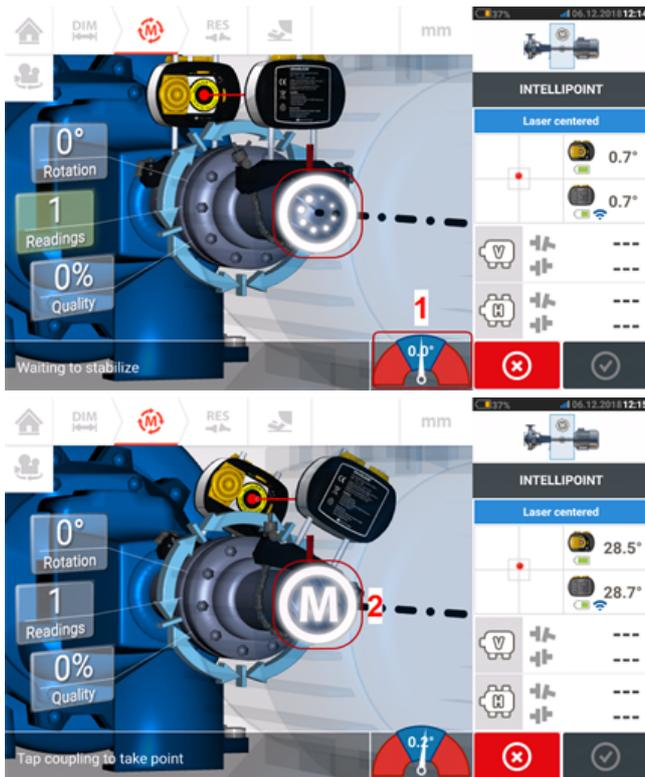
Drehen Sie beide Messkomponenten in die nächste Messposition. Wiederholen Sie den Vorgang, um Messungen an mindestens drei Positionen über einen Rotationswinkel von mindestens 60° vorzunehmen. Es wird jedoch empfohlen, mehr Messungen über einen größeren Winkel vorzunehmen.
