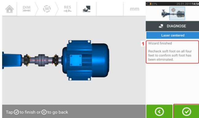
Nachdem alle gegebenen Assistentenschritte ausgeführt wurden, erscheint die Meldung "Assistent abgeschlossen" (Wizard finished) (1).
