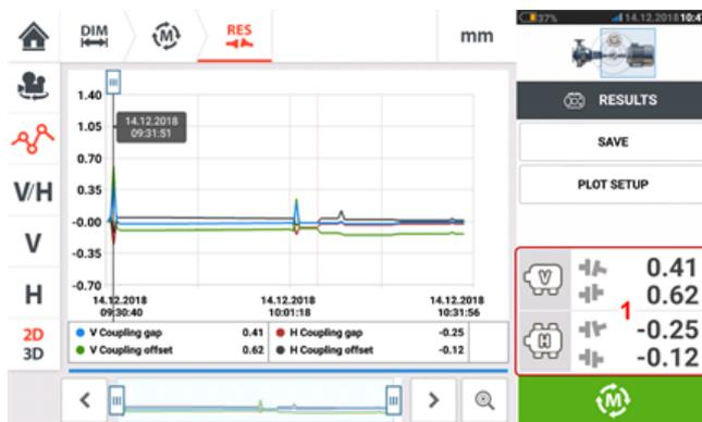
Tippen Sie auf den Bereich, in dem die Kupplungsergebnisse angezeigt werden **(1)**. Hierdurch wird das Live Trend-Log geöffnet.
