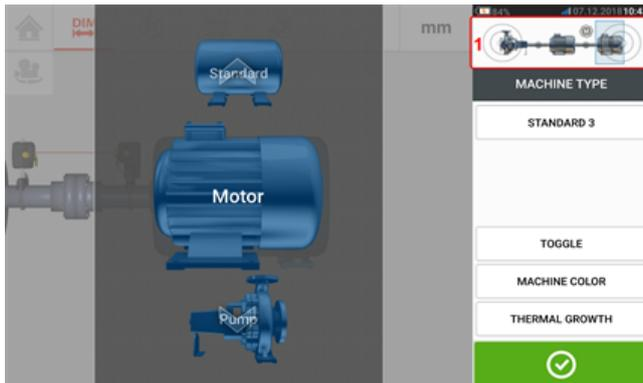
Um auf die verschiedenen Elemente im Maschinenzug zuzugreifen, tippen Sie auf das entsprechende Element in der Maschinenzug-Karte [ **1** ] in der oberen rechten Ecke des Bildschirms.
