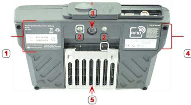
**1:** Kennzeichnung mit Seriennummer und Teilnummern, Informationen zur wiederaufladbaren Batterie und Entsorgung **2:** Stecker für Kamera-LED **3:** Kameralinse **4:** RFID-Kennzeichnung, Funkzertifizierungen und FCC-Kennzeichnung **5:** Flexibler Standfuß in geschlossener Position
