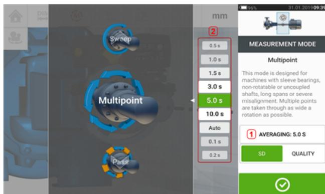
Wählen Sie die Mittelungsfunktion aus, indem Sie auf den 'Mittelung'-Button [1] tippen. Eine Skala [2] zur Einstellung des Mittelungswerts wird auf dem Bildschirm eingeblendet. Tippen Sie auf den gewünschten Mittelungswert, der daraufhin in dem 'Mittelung'-Button erscheint [1].
