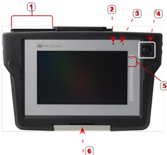
**1:** USB-Anschluss, Sensoranschluss und Ladeanschluss **2:** Umgebungslichtsensor **3:** Bluetooth-Kommunikations-LED **4:** Einschalttaste **5:** Batteriestatus-LEDs **6:** Flexibler Standfuß
