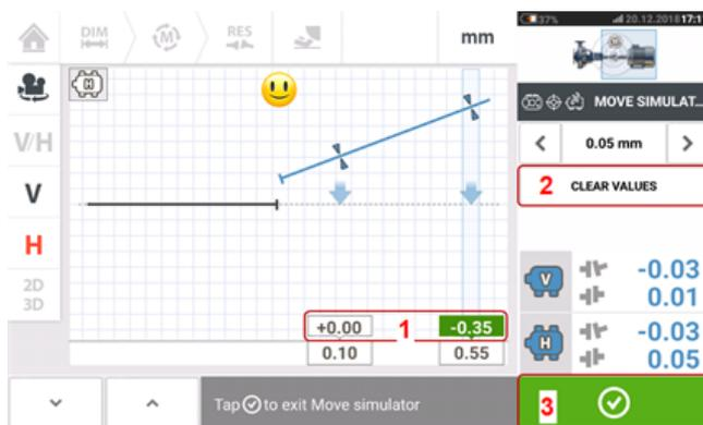
Das Maß und die Richtung, in die das Aggregat bewegt werden sollten, werden in den Wertefeldern (1) über den gemessenen Fußwerten angezeigt.
