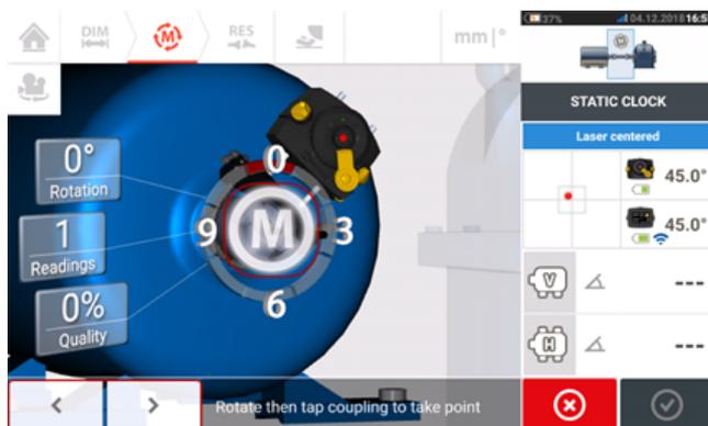
6. Wiederholen Sie die Schritte 4 und 5, um Messungen an mindestens drei Uhrpositionen über einen Drehwinkel von mindestens 70° vorzunehmen. (Je mehr Messpunkte Sie aufnehmen, desto zuverlässiger werden die Ergebnisse.)
