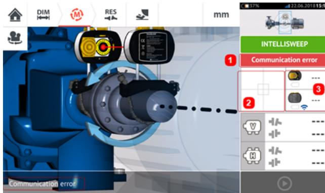
Tippen Sie auf den Detektorbereich [2] oder den Sensor/Laser-Bereich [3], um auf den Menüpunkt 'Sensorliste' zuzugreifen.
