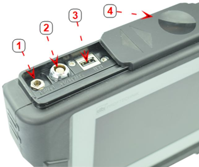
**1:** Netzstecker für Ladegerät **2:** Universal-Stecker für Sensor, PC und Ladegerät **3:** USB-Host-Stecker für USB-Speichergerät (zum Speichern von Messdateien (Anlage) und Durchführen von Firmware-Updates) **4:** Bewegliche Staubschutzkappe
