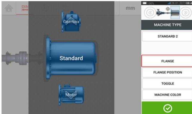
Über die Menüoptionen auf dem Bildschirm können Sie den Maschinennamen ändern, den Bildschirm "Flange details" (Flanschdetails) aufrufen, die Flanschposition in Bezug auf die Welle ändern, die Maschine entlang der Schaftachse kippen (wechseln) und die Maschinenfarbe bearbeiten.
