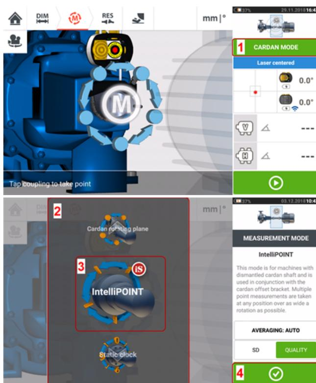
3. Tippen Sie auf **1**, um den Messmodus-Bildschirm (Measurement Mode) zu öffnen.
