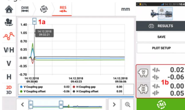
Die Cursor-Position (1a) entspricht der im Log markierten Messung. Die angezeigten Kupplungsergebnisse (1b) entsprechen den im Log markierten Ergebnissen.
