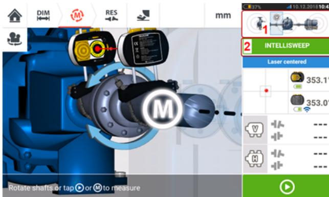
In diesem Beispiel wird für die Messung der Kupplung IntelliSWEEP als Messmodus verwendet.
