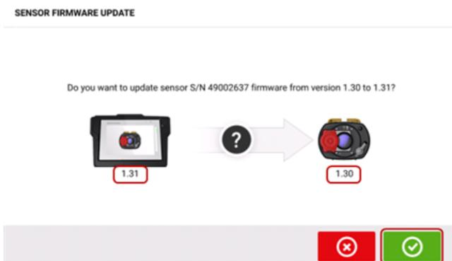
Auf dem Bildschirm wird darauf hingewiesen, dass eine neuere Sensor-Firmware über das robuste Touch-Gerät verfügbar ist. Tippen Sie auf
