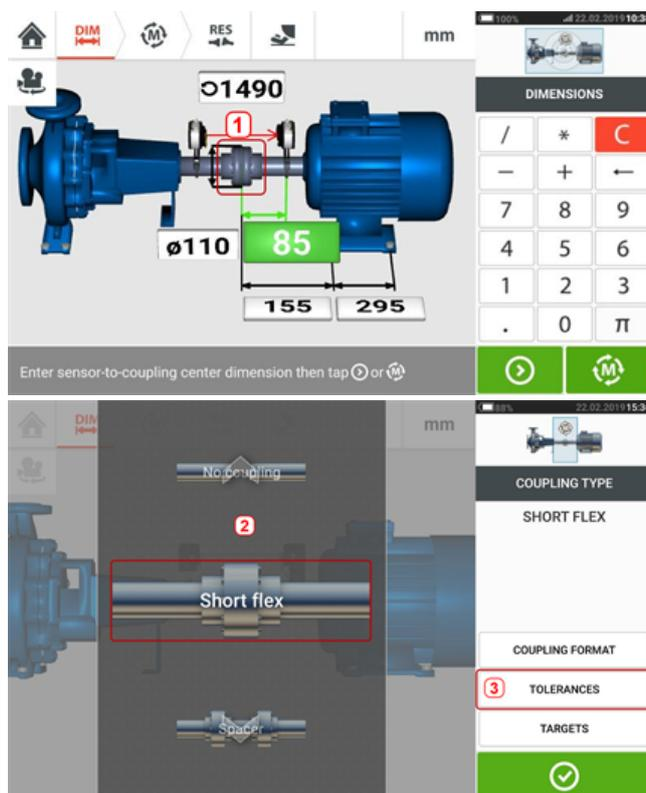
Tippen Sie auf Kupplung (1) und wählen Sie dann die gewünschte Kupplungsart (2) mithilfe des Karussells aus. Tippen Sie auf "Toleranzen" (Tolerances) (3), um die Kupplungstoleranzentabelle zu öffnen.
