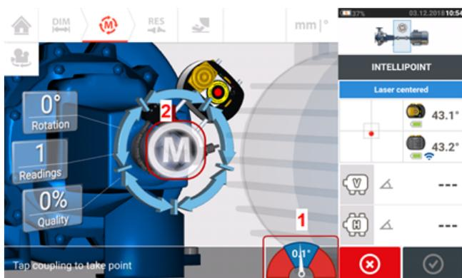
6. Una vez se haya estabilizado la medición, pulse 'M' (2) para tomar la medición.
