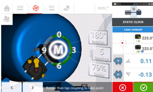
7. Cuando se hayan tomado suficientes puntos de medición a lo largo de al menos 70° de rotación, pulse
