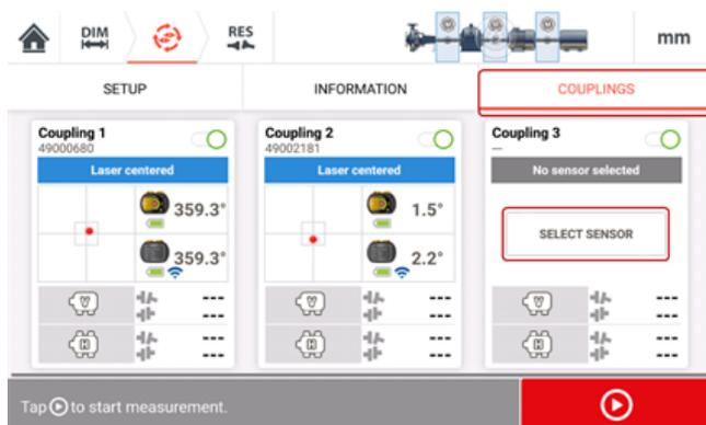
Pulse "Select sensor" (Seleccionar sensor) y proceda con el inicio del sensor.
