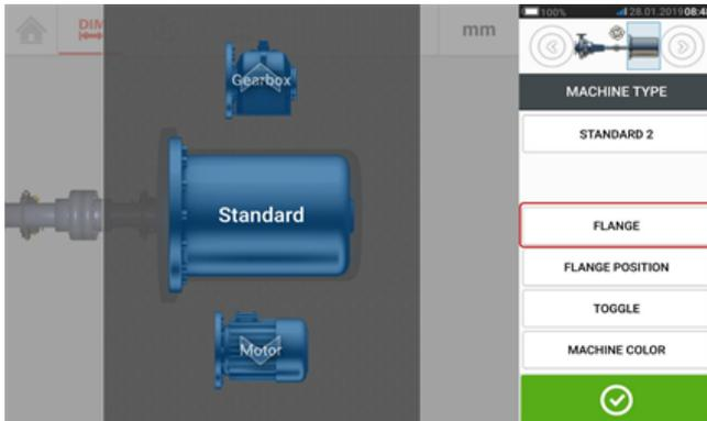
Los elementos de menú mostrados en la pantalla pueden usarse para editar el nombre de la máquina, acceder a la pantalla "Detalles de brida", cambiar la posición de las bridas con respecto al eje, voltear la máquina a lo largo de la línea central del eje (alternar) y editar el color de la máquina.
