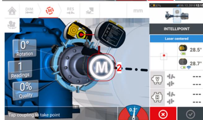
Gire cualquiera de los cabezales hasta la siguiente posición de medición; repita el procedimiento para tomar mediciones a través de al menos tres posiciones a lo largo de 60° de giro, aunque se recomienda realizar más mediciones sobre un ángulo más amplio.
