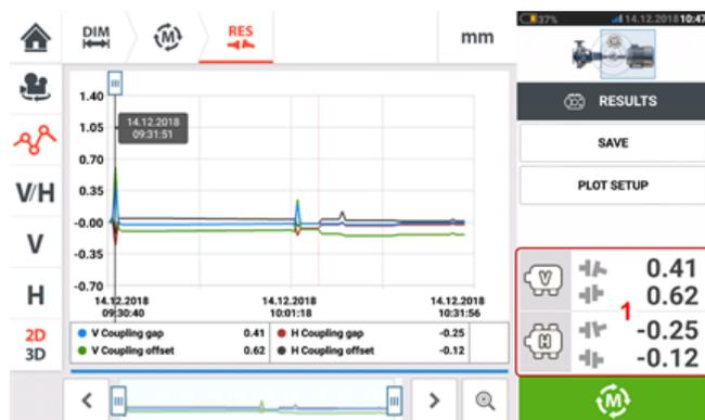
Pulse sobre el área donde se muestran los resultados de acoplamiento **(1)**. Se abrirá el registro Live Trend
