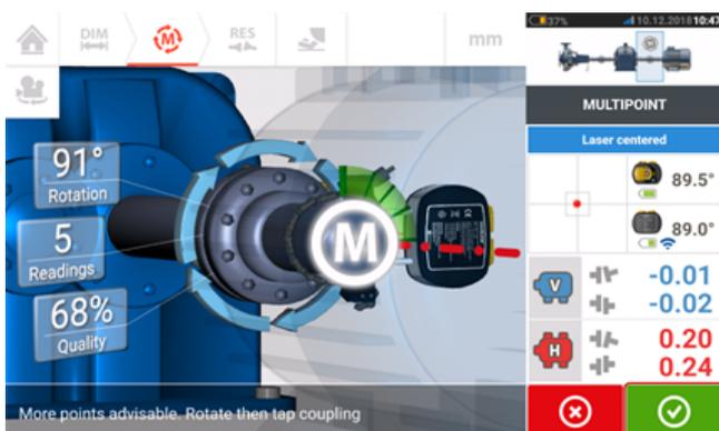
Cuando la medición a lo largo de ambos acoplamientos se haya completado, toque
