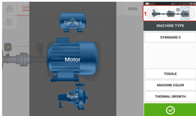
Para acceder a los diferentes elementos del tren de máquinas, pulse el elemento correspondiente dentro del minirecuerdo del tren [1], ubicado en la esquina superior derecha de la pantalla.
