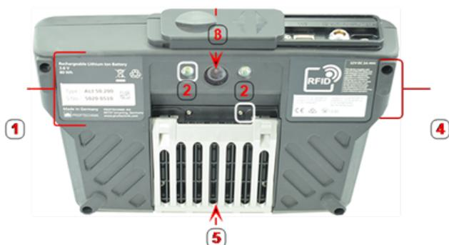
**1:** Etiqueta con los número de serie y pieza del dispositivo, detalles sobre la batería recargable y desecho; **2:** conector del LED de la cámara; **3:** lentes de la cámara; **4:** etiqueta RFID, certificados de radio y aviso de la FCC; **5:** pie versátil en posición cerrada
