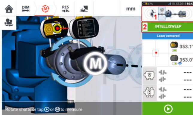
En este ejemplo, el modo de medición usado para medir el acoplamiento es IntelliSWEEP.
