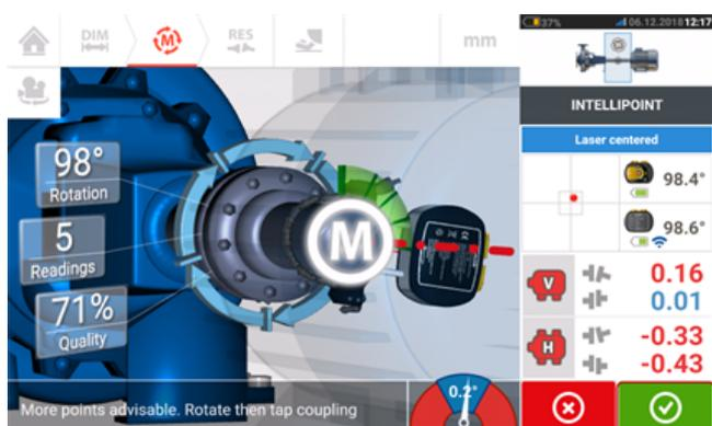
Tras tomar suficientes puntos de medición, pulse
