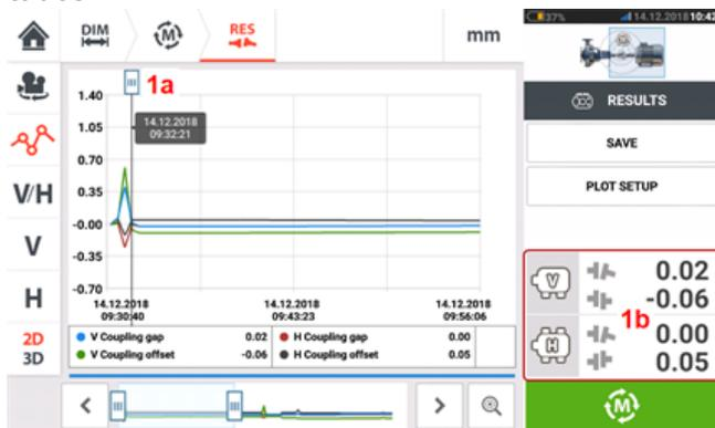
La posición del cursor **(1a)** se corresponde con la lectura seleccionada en el registro. Los resultados de acoplamiento mostrados **(1b)** se corresponden con aquellos seleccionados en el registro.
