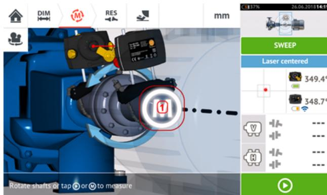
Una vez que el haz láser ha sido centrado, puede iniciarse la medición automáticamente cuando se giran los ejes o pulsando
