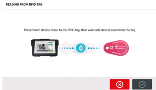
Posicione el dispositivo táctil de tal modo que su módulo NFC integrado se encuentre tan próximo a la etiqueta RFID como sea posible (menos de un centímetro).
