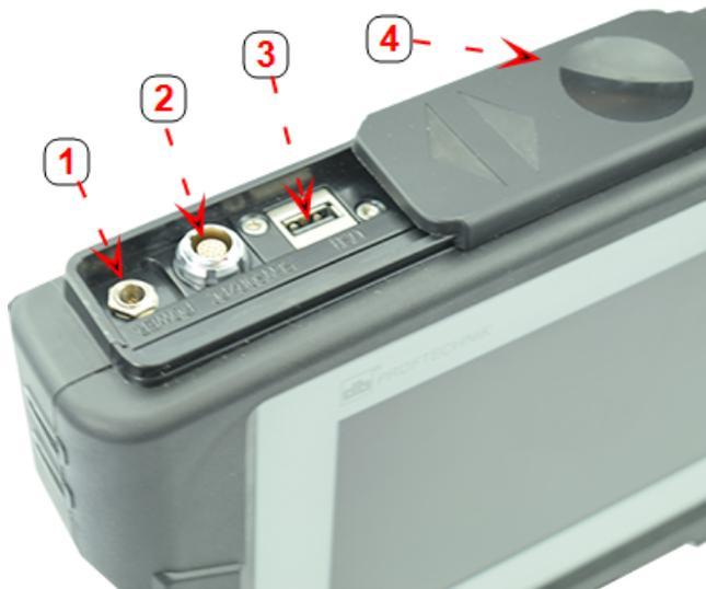
**1:** conector de corriente para cargador; **2:** conector universal para sensor, PC y cargador; **3:** conector host USB para el dispositivo de memoria USB (para guardar archivos de medición de instalaciones y llevar a cabo actualizaciones de firmware); **4:** Tapa protectora deslizante
