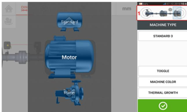
Per accedere ai diversi elementi all'interno del treno macchina, toccare l'elemento corrispondente all'interno del mini-riquadro del treno [1] sull'angolo superiore destro della schermata.
