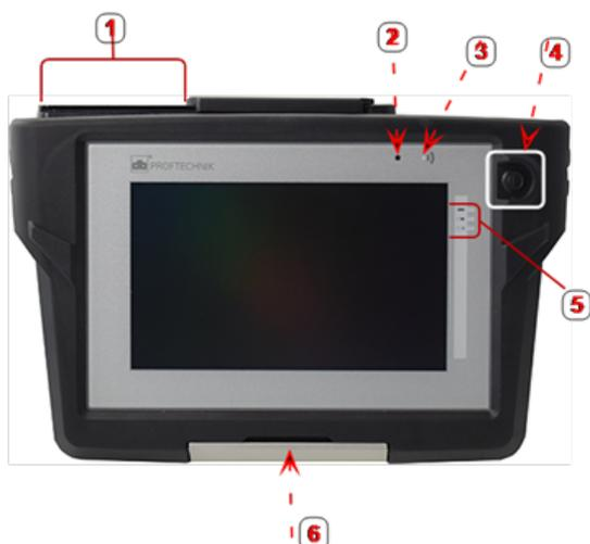
**1:** Porta usb, sensore e prese di ricarica; **2:** Sensore di luce ambientale; **3:** LED di comunicazione Bluetooth; **4:** Tasto di accensione; **5:** LED di stato batteria; **6:** Supporto versatile
