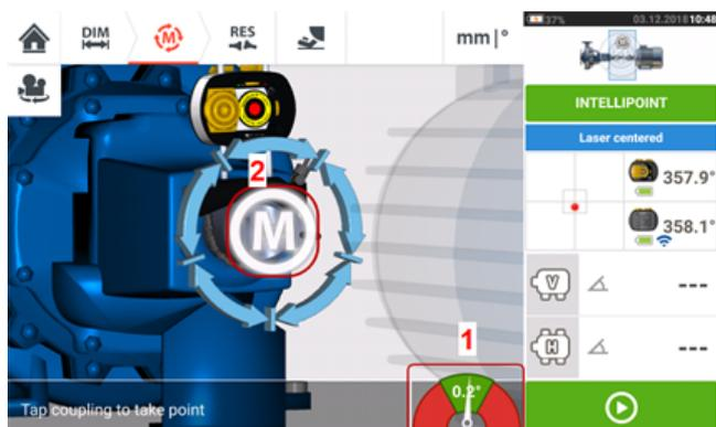
1. Con il fascio laser centrato e l'ago posizionato precisamente al centro del settore verde (1), attendere la stabilizzazione della misurazione.
