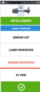
È possibile trovare la data di scadenza dell'ispezione del laser anche in "Laser properties" (Proprietà del laser).
