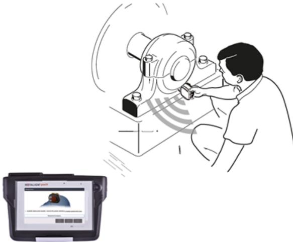
Con la sonda saldamente bloccata in posizione, mantenendo il sensore saldamente, posizionarla sulla posizione di misurazione appropriata.
