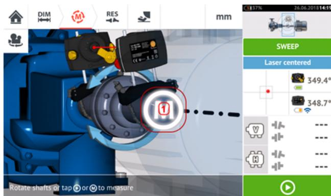
Una volta centrato il fascio laser, la misurazione può essere avviata automaticamente quando gli alberi sono ruotati o sfiorando
