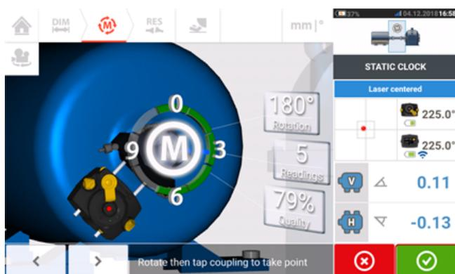
7. Quando saranno stati acquisiti abbastanza punti di misurazione lungo una rotazione pari ad almeno 70°, sfiorare
