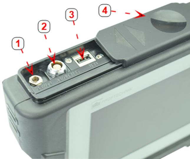
**1:** Connettore di alimentazione per il caricatore; **2:** Connettore universale per sensore, PC e caricatore; **3:** Connettore host USB per dispositivo di memoria USB (per salvare file di misurazione delle risorse ed eseguire aggiornamenti firmware); **4:** Calotta anti-polvere scorrevole
