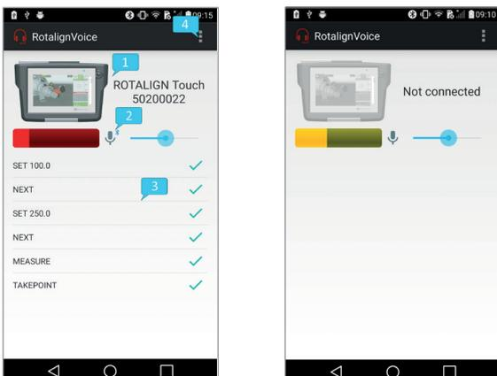
Figura 1: pantalla principal de la aplicación cuando está conectada a ROTALIGN touch (a la izquierda) y cuando está desconectada (a la derecha)
