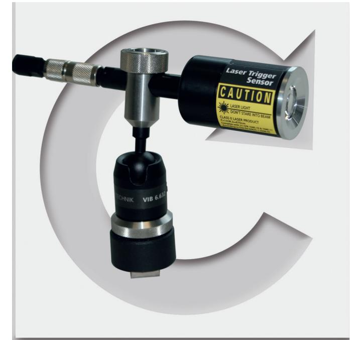
El disparador láser / sensor de RPM (abreviado: sensor) se emplea como disparador para mediciones de vibración y de RPM con un colector de datos de medición de PRUFTECHNIK.
