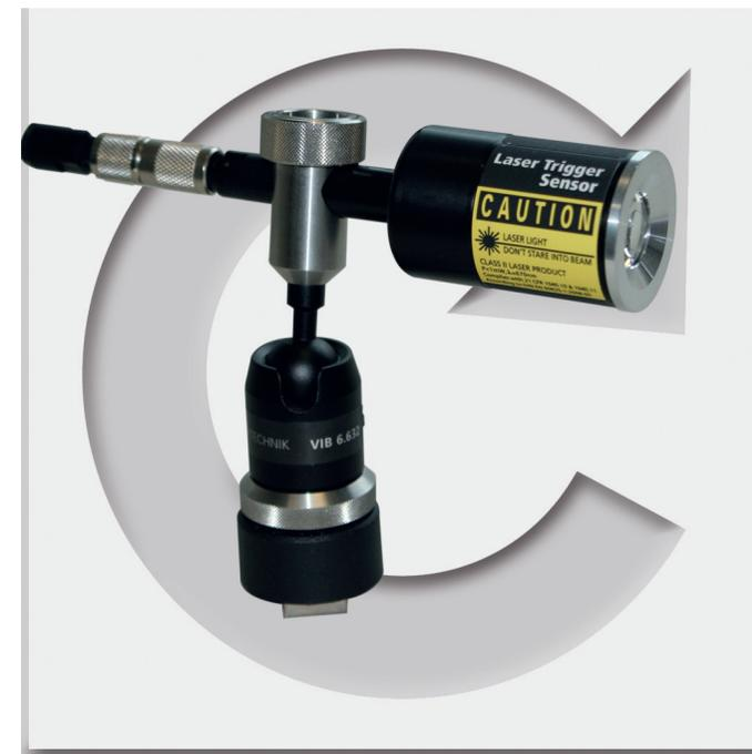
Le déclencheur laser/capteur de vitesse de rotation (en bref : le capteur) est utilisé comme déclencheur pour la mesure des vibrations et pour la mesure de la vitesse de rotation avec un collecteur de données PRUFTECHNIK.
