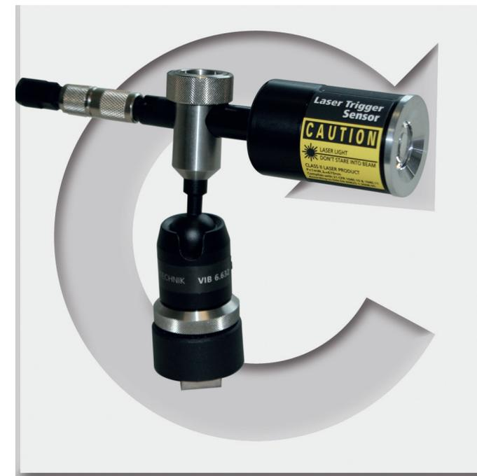
Il trigger laser / sensore di numeri di giri (in breve sensore) è utilizzato come trigger per la misura delle vibrazioni e del numero di giri con uno strumento di raccolta dei dati misurati PRUFTECHNIK.
