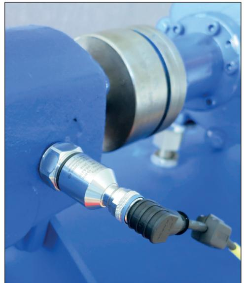
Les capteurs des gammes VIB 6.172 et VIB 6.210 permettent de mesurer le niveau de vibration absolu des boîtiers des machines avec composants rotatifs dans un environnement industriel. La limite inférieure des fréquences sert à analyser les vibrations, même au niveau de composants tournant à très faible vitesse ( $n \geq 6 \text{ min}^{-1}$ ) – par ex. au niveau du palier principal d'une éolienne. Les capteurs présentent une sortie de tension conforme à la norme IEPÉ\*.
