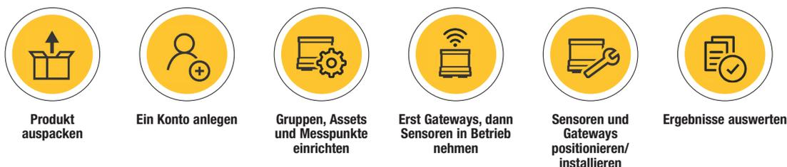
Abbildung 1. Der 3563 Sensor zur Schwingungsanalyse: Ablauf von Konfiguration, Inbetriebnahme und Installation.
