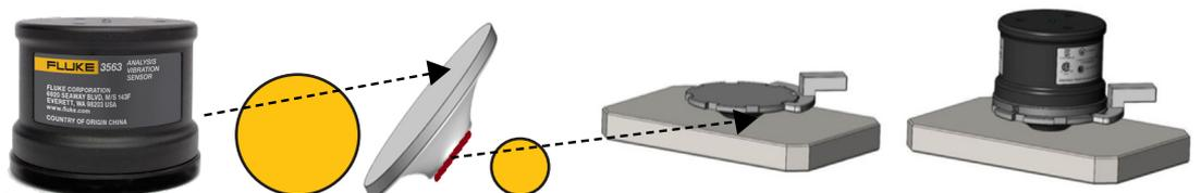
Le due scelte sono montaggio a vite e montaggio epossidico:
