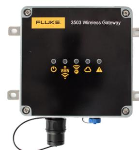
La comunicazione tra gateway e Accelix è basata sulla tecnologia IoT (MQTT) ed è bidirezionale. I dati di misurazione acquisiti dal sensore sono elaborati in Accelix.
