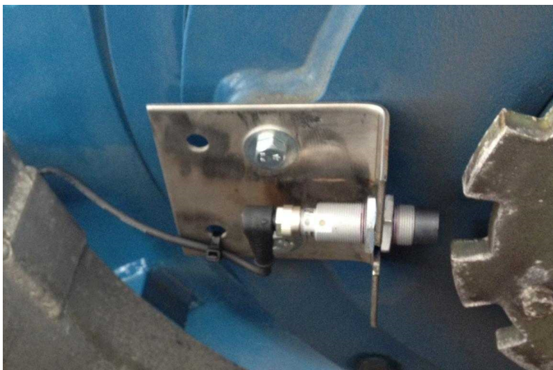
Sensor de velocidad de rotación montado; arandela dentada actuando como un generador de impulsos.
