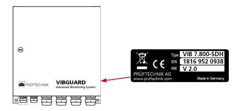
La placa de características ubicada sobre la carcasa de protección o junto al cableado de la fuente de alimentación contiene información relativa al sistema en conjunto:
