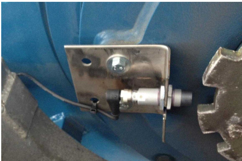
Drehzahlsensor montiert, Zahnscheibe als Impulsgeber.
