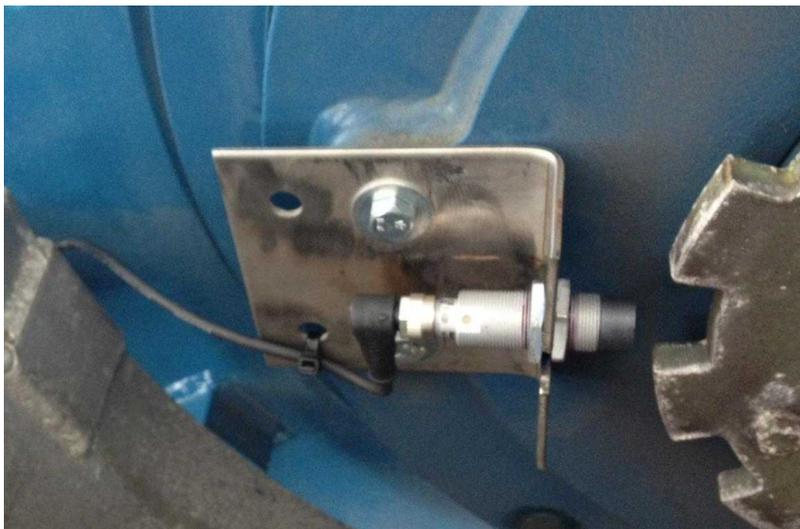
Le capteur de vitesse de rotation est monté, la roue dentée donne les impulsions.
