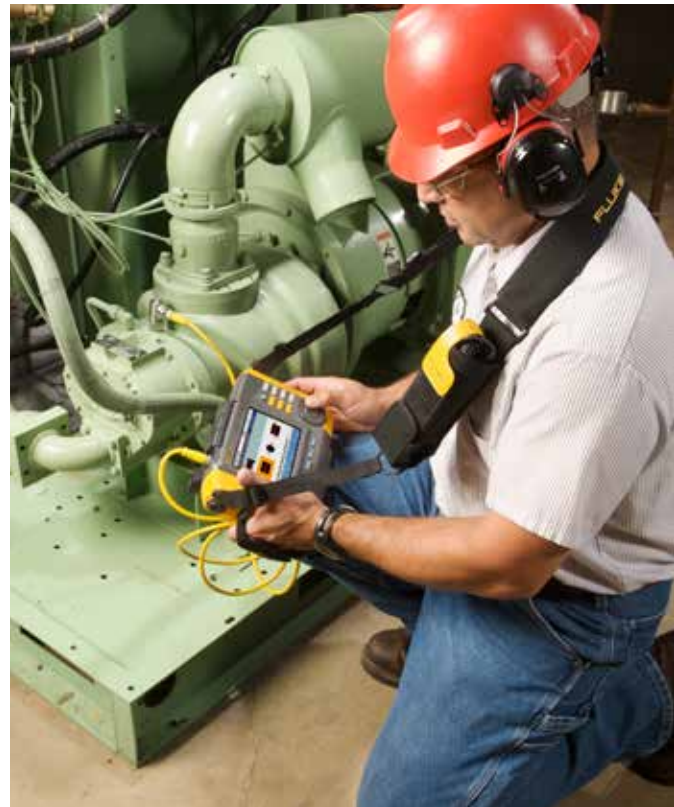
Diagnostiquez les défauts courants avec le testeur de vibrations Fluke 810.
