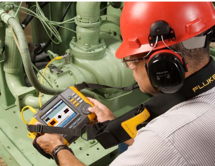
Il pluripremiato misuratore di vibrazioni Fluke 810 utilizza un programma di diagnostica automatica che aiuta i lavoratori a rimanere efficienti.
