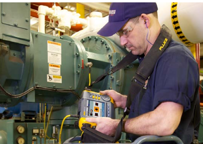
Il pluripremiato misuratore di vibrazioni Fluke 810 utilizza un programma di diagnostica automatica che aiuta i lavoratori a rimanere efficienti.
