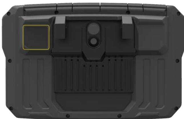
Die Identifizierung erfolgt über mitgelieferte RFID-Tags. Das Tag ist an einem Asset angebracht. Zum Auslesen des Tags führen Sie das Lesemodul so nah wie möglich an das Tag heran (möglichst bis auf 5 mm).
