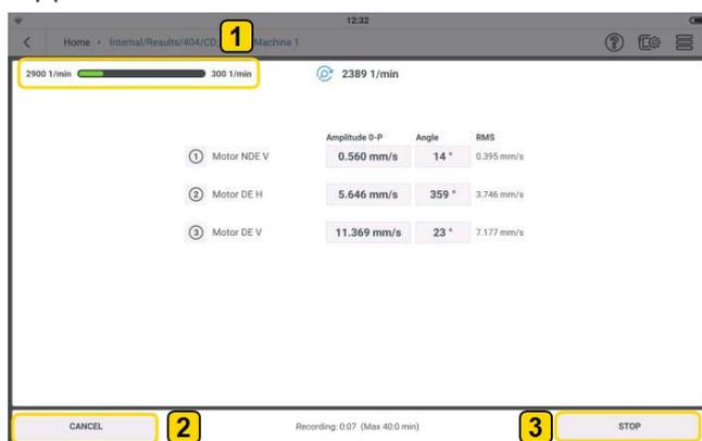
Der Fortschrittsbalken (1) zeigt die Erfassung der Daten an. Sobald die Datenerfassung beginnt, wird dieses Ereignis erstellt und dann aufgelistet, es sei denn, die Datenerfassung wird abgebrochen (2). Wenn die Datenerfassung gestoppt wird (3), wird dieses Ereignis erstellt und aufgelistet.
