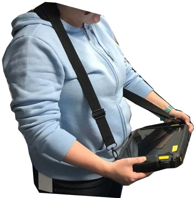
Utilice las hebillas para ajustar la longitud de las correas de mano. Cuando el tamaño de las correas de mano sea el correcto, utilice los cierres de velcro para envolver las correas. Esto le proporciona un agarre fiable y cómodo.
