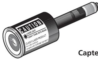
Capteur optique laser (VIB 6.631)
