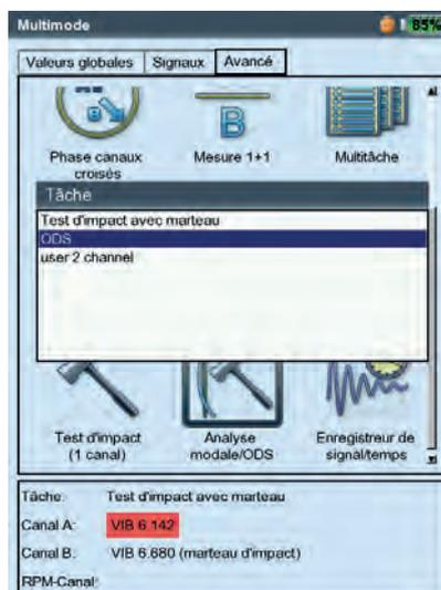
Raccordez le marteau à impulsions avec capteur de puissance au canal B et le capteur de la réponse système au canal A (systématiquement). Une fois la dernière mesure individuelle terminée, sauvegardez l'ensemble de données dans un fichier.
