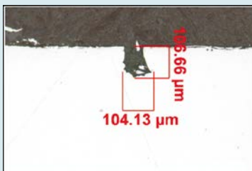
Schliffbild 1 Fehlertiefe: 0,1 mm
