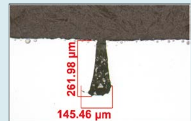
Schliffbild 2 Fehlertiefe: 0,26 mm
