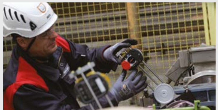
Laseroptisches Ausrichten einer montierten Kardanwelle
