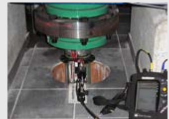
Abb. 4: Mobile Lastmessung an einer kleinen Wasserkraftanlage
