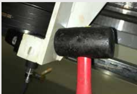
Abb. 2: Anschlagversuche am Gehäuse
