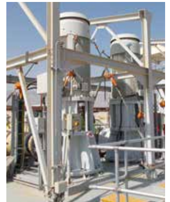
Abb. 1: Simulieren von Versteifungen mit Kettenzügen
